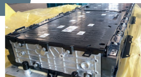
Komplette Hochvoltbatterie wird für die Montage vorbereitet.
